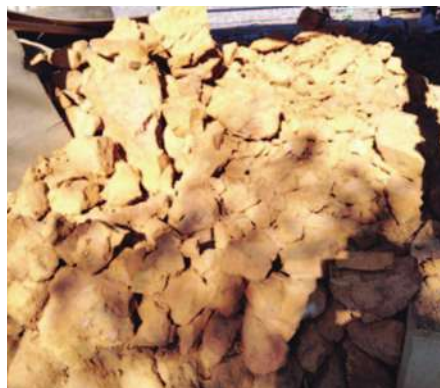
写真は色土。和室の壁などに塗られる事の多い京壁(稲荷山)の原石。これを砕いて土に返していきます
