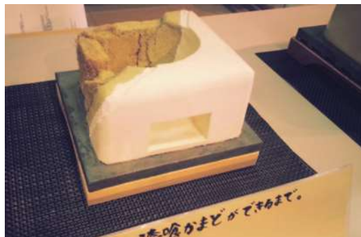
かまどは土で作り表面は漆喰仕上でより耐久性を確保しています。小さい熱源でもかまどの中で輻射(赤外線)が起きエネルギーを蓄えて調理が可能。この「漆喰かまど」も市販の30gの固形燃料1個で1合にお米を炊く事ができます
