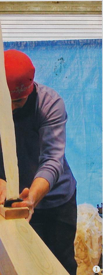
弊社では、国産材で天然乾燥、大工は手刻みが標準なのですが、現在の市場は大きく変わっています。身近な違いの例では、天然乾燥の無垢材は、画像の様に綺麗に鉋(カンナ)※画像①がかけられます。人工乾燥の木は、表面の細胞が破壊されているので、艶や粘りがなく、薄く鉋がかけづらいのが特長でボロボロの屑の様になつてしまします。最近は、大工も構造材の加工で手刻み※画像②を行わず、プレカット工場(機械加工)に頼り、鉋※画像③も持つてい
